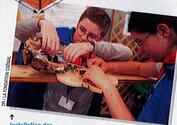
Installation des capteurs dans un boîtier, décoré de rondelles de bois pour lui donner l'apparence d'une carapace de tortue !
